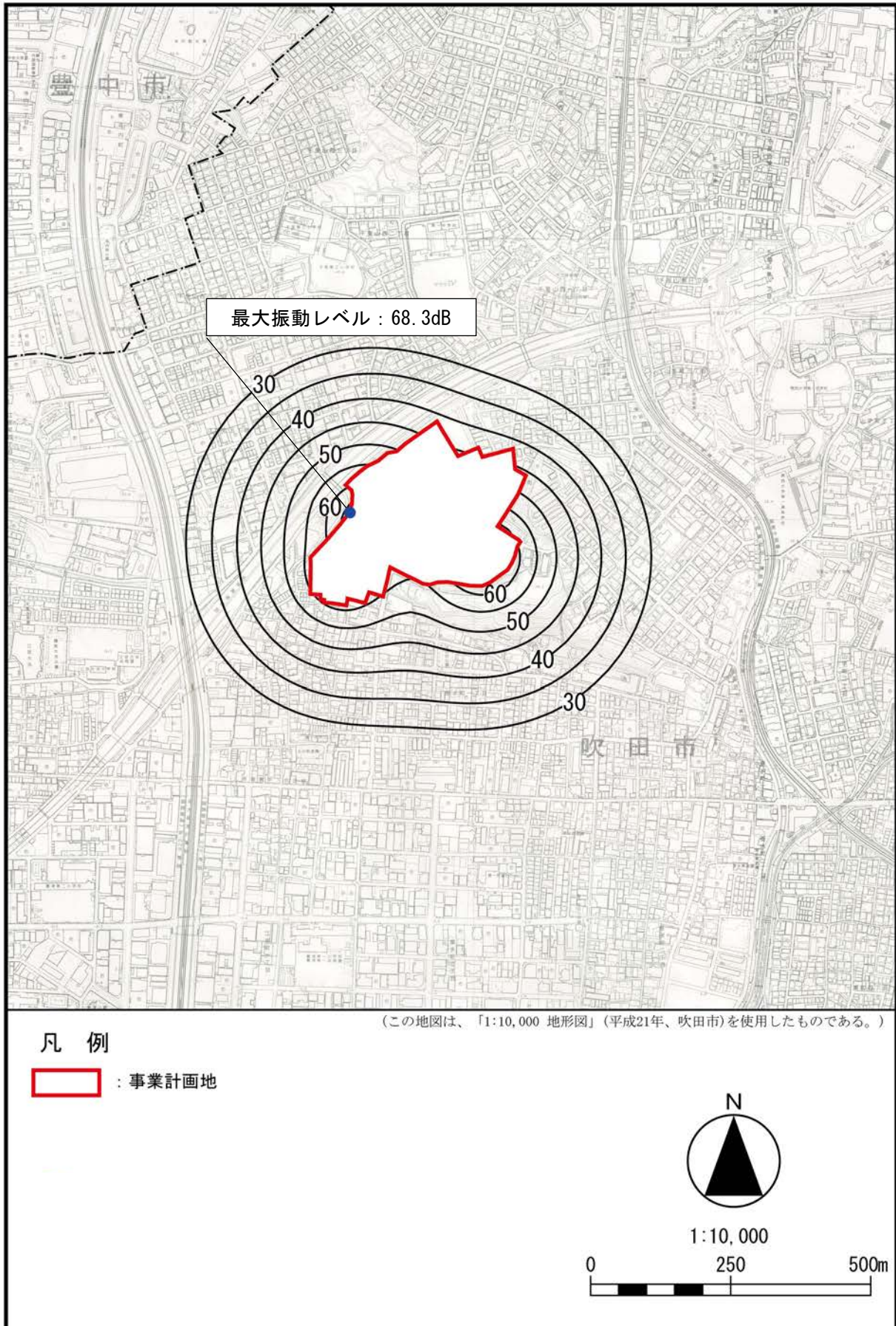
図12.8-4(2) 建設機械の稼動による振動予測結果 (着工後9ヶ月目/解体工事時期)
