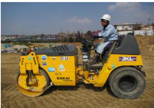
コンパインドローラ(振動ローラ、4.0t級)
